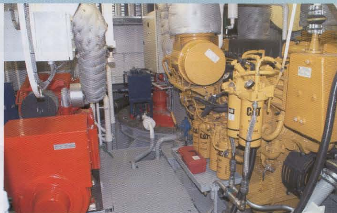
746 kW leistet jede der beiden Caterpillar-Hauptmaschinen | Bilder: Pospiech
